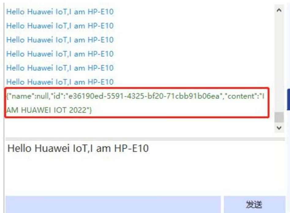
串口端收到华为云平台向设备发送的消息数据。
